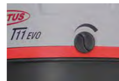
Leistungsregulierung zur optimalen Einstellung auf jeden Bodenbelag.
