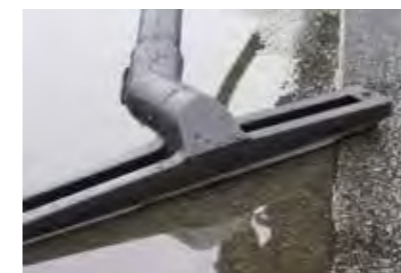
Die 360 mm breite Nassbodendüse im Einsatz auf dem Flachdach.
